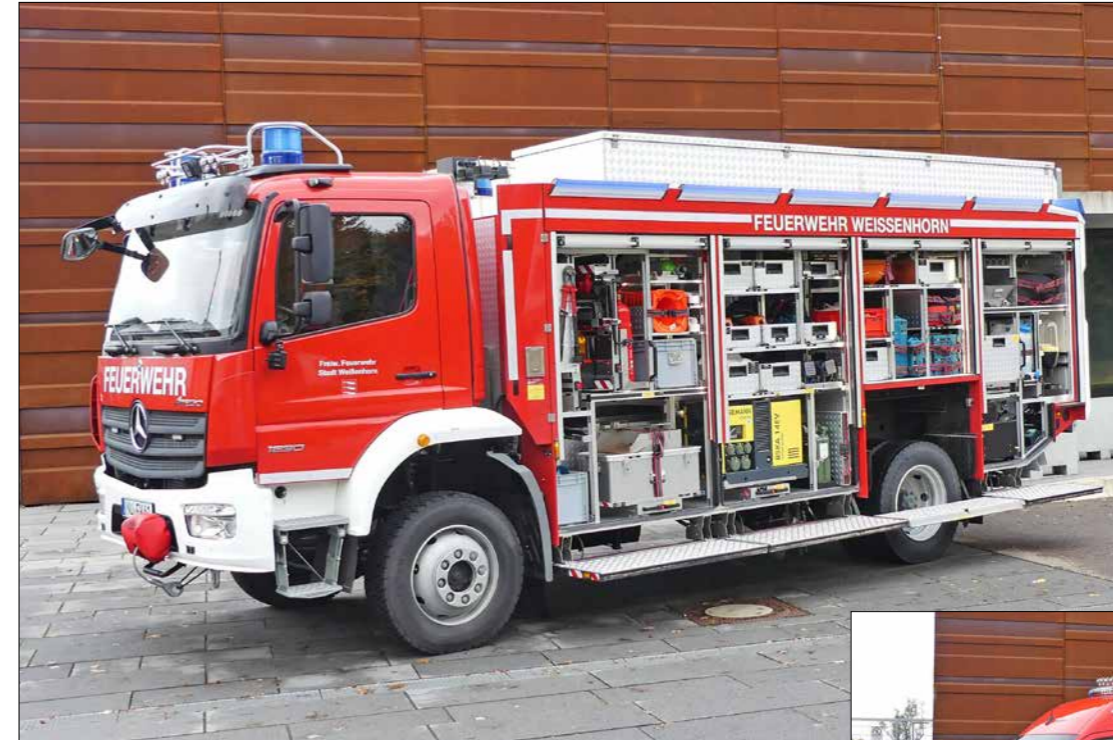
Rüstwagen RW Indienststellung: September 2020 Für technische Hilfeleistung
