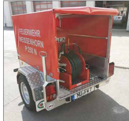
Pulverlöschanhänger P250 Indienststellung: 2017 Führt Löschpulver der Brandklassen A/B/C mit
